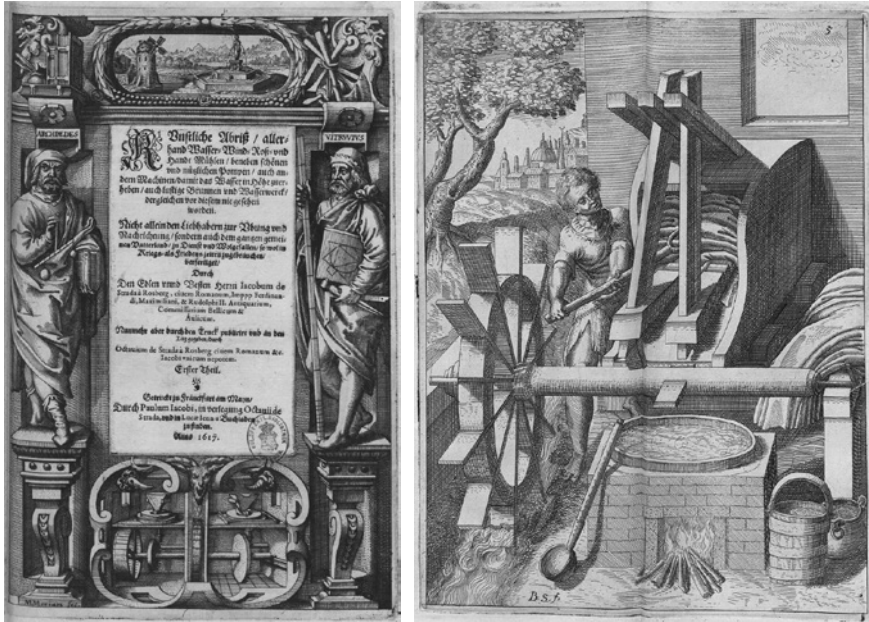
FIGURES 14.50–14.51 Jacopo Strada, Künstliche Abriß / allerhand Wasser-, Wind-, Roß, und Handt mühlen , Frankfurt a.M. 1617, titlepage and design for a water-driven fulling mill.
